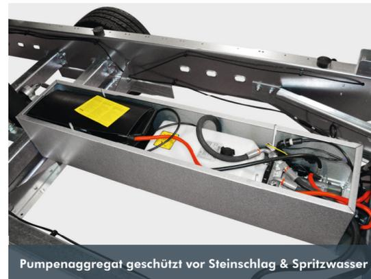
Pumpenaggregat geschützt vor Steinschlag & Spritzwasser
