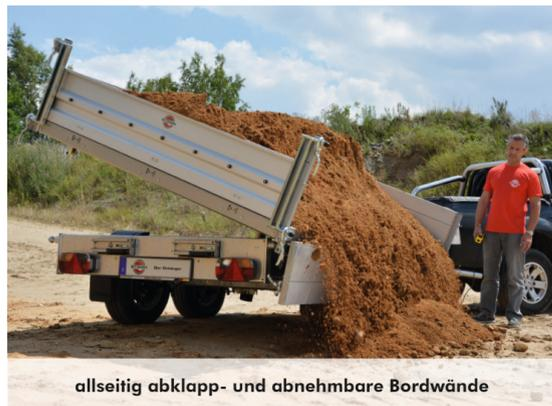
allseitig abklapp- und abnehmbare Bordwände
