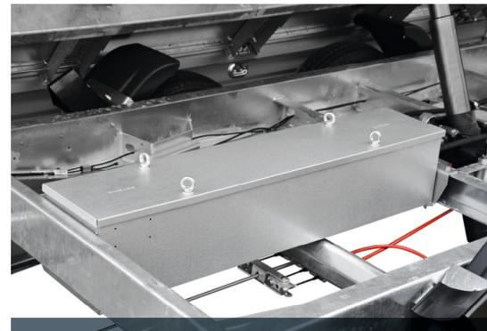
Pumpenaggregat geschützt vor Steinschlag & Spritzwasser
