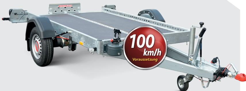
Der neue **WOM 1300** wurde mit einer extrem stabil geschweißten Rahmenkonstruktion einschließlich **integrierter Reling** ausgestattet.
