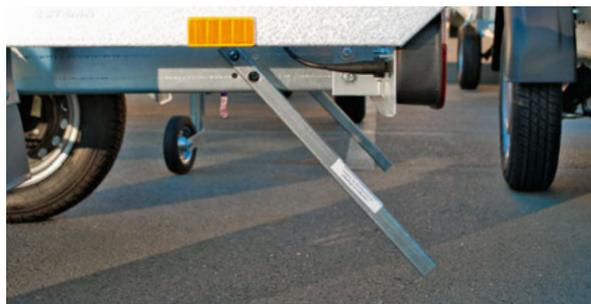
Stützeinrichtung Motorradtransporter - MT750
