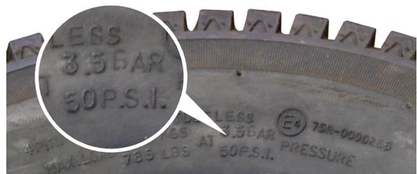
Diese Angabe in bar und P.S.I. steht für den max. Fülldruck des Reifens bei Vollast. Finden Sie dort keine Angabe, so sind diese aus der Tabelle zu entnehmen.
