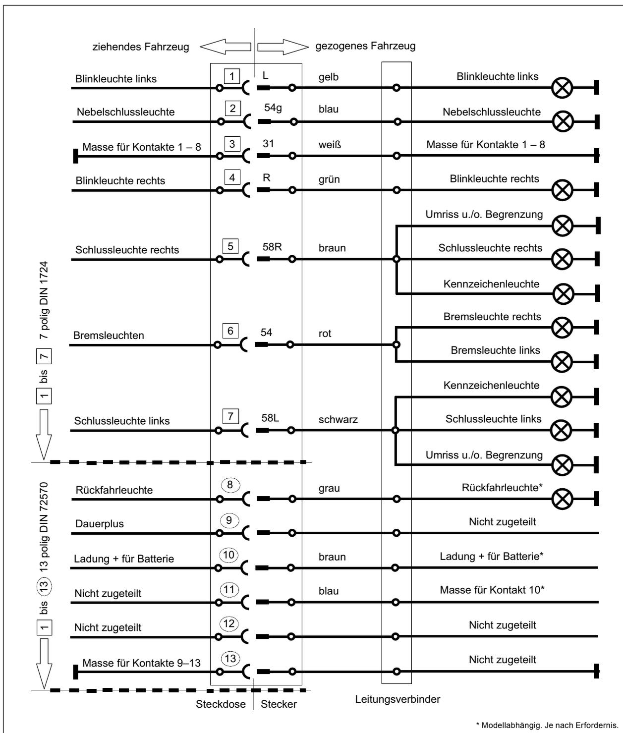
Anschlussplan 7/13 polig 12 Volt nach DIN 1724/72570
